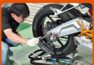
④お助けリフターAの取っ手を後方に引きながら、リアタイヤを上下させて アクスルシャフトが通る様に穴位置をセット。あとはアクスルシャフトを差し込むだけ。
