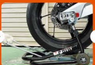
④お助けリフターAの取っ手を後方に引きながら、リアタイヤを上下させて アクスルシャフトが通る様に穴位置をセット。あとはアクスルシャフトを差し込むだけ。
