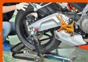
②お助けリフターAに乗せるように タイヤをセットする。
