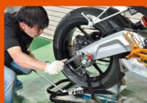
④お助けリフターAの取っ手を後方に引ながら、リアタイヤを上下させて アクスルシャフトが通る様に穴位置をセット。あとはアクスルシャフトを差し込むだけ。
