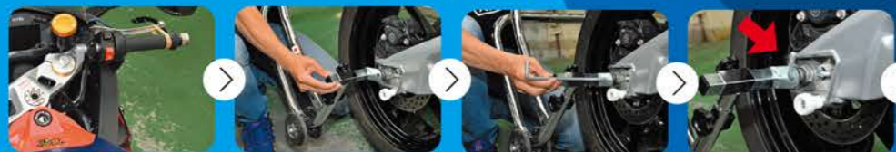
①ブレーキレバーを、何かで ロックする。ステアリングは 必ず左いっぱい切る。 ②高さは2段目に調整し、 軸を適度に調整する。 ③シャフトで貫通させます。最後までしっかりと貫通させます。
