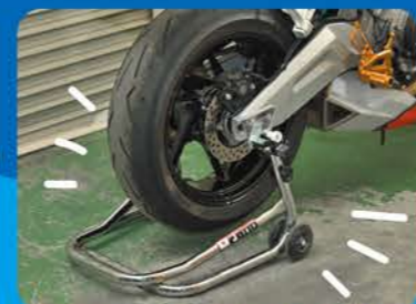
④反対側はこうになります。 ⑤バイクを両手で直立させる。 左足(軸足)は車輪のところ。 ここが立ち位置。 これ、とっても重要。 ⑥ここでシートベルトがタンデムグリップを左手で持ち、右手はさらに 後ろあたりに手を添え、右の車輪が地面に付くまでバイクを 起こすスタンドの一番後端を踏み、シートカウルとスタンドを 引き離すようにもぐり込ませる。
