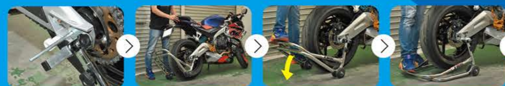
④反対側はこうになります。 ⑤バイクを両手で直立させる。 左足(軸足)は車輪のところ。 ここが立ち位置。 これ、とっても重要。 ⑥ここでシートベルトがタンデムグリップを左手で持ち、右手はさらに 後ろあたりに手を添え、右の車輪が地面に付くまでバイクを 起こすスタンドの一番後端を踏み、シートカウルとスタンドを 引き離すようにもぐり込ませる。
