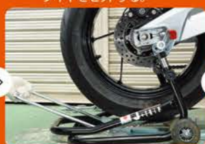
④お助けリフターAの取っ手を後方に引ながら、リアタイヤを上下させて アクスルシャフトが通る様に穴位置をセット。あとはアクスルシャフトを差し込むだけ。
