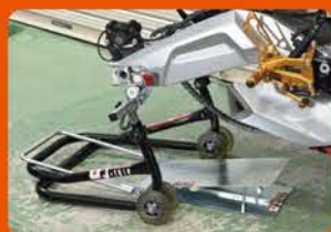
①お助けリフターAを 写真の様な位置にセットする。
