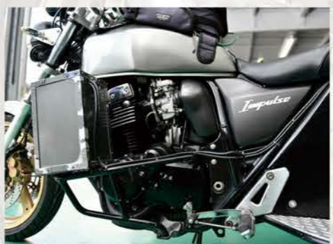
左右にあるハンドメイドのボックスには中継用カメラ電源のリチウムバッテリーが各4本入る
