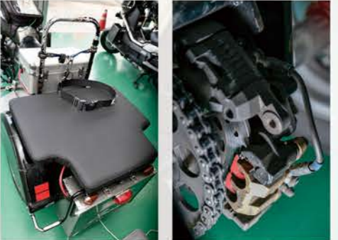
カメラマンはハーネスで固定され前後やローアングルも撮影可能。リアブレーキキャリアはダブルで装着
