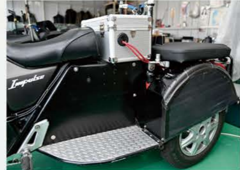
左右ステップボードには機材用バッテリーを配置。アルミボックスの上にはマイクロ・ヘッド・アンプなど送信機材が重ねられる
