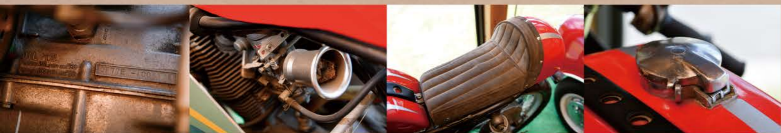
CP77Eの刻印が305ccの証 ケイビンCRキャブレターが2連装 シングルシートもレーサーRCを忠実に再現 タンクキャップもCR110タイプという拘り様
