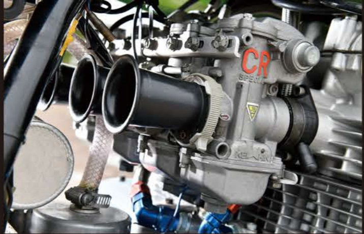
写真右上: キャブレターはケイヒンのCR。旧車には丸ボディのCRが似合う。 写真左上: パンク角を確保する為のジェネレーターカバー加工は必須。 エンジン排気量は1165ccになっている。 写真左下: レース車検合格ステッカーもこのZの履歴書となる。
