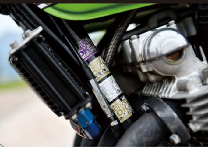
写真右上: キャブレターはケイヒンのCR。旧車には丸ボディのCRが似合う。 写真左上: パンク角を確保する為のジェネレーターカバー加工は必須。 エンジン排気量は1165ccになっている。 写真左下: レース車検合格ステッカーもこのZの履歴書となる。
