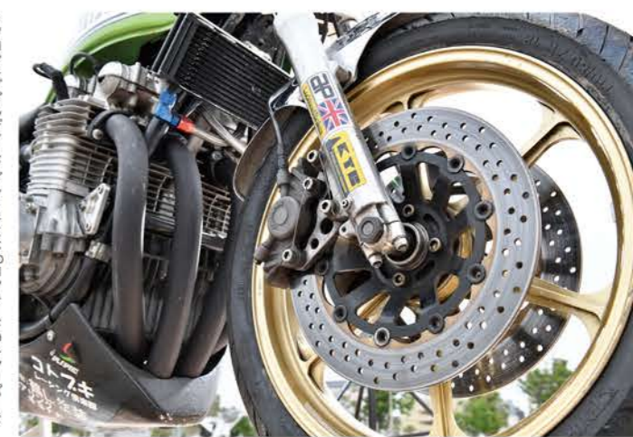
「フロントダブルディスクブレーキには30ロックのキャリパーをチョイス。」
