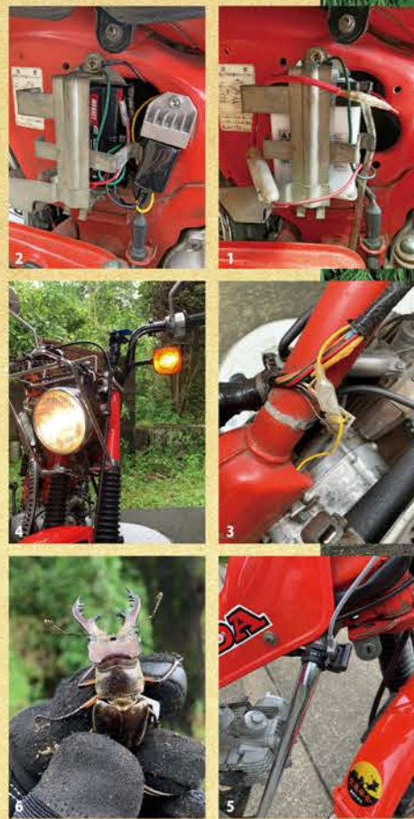
1: ノーマルの6Vバッテリーが収まった状態 2: 12Vシールドバッテリーやレギュレーターを取めた状態 3: 付属の分岐タップは使用せずにキボシ端子で分岐 4: アイドリングでも煌々と光るウィンカー! (笑) 5: 12VコンパートついでにUSBも設置 6: 試走中に会った激レアなミヤマクワガタ
