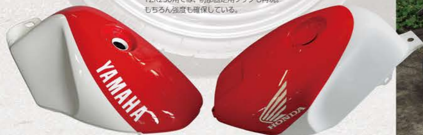
TZR250用では、前部固定用フックも再現。もちろん強度も確保している。
