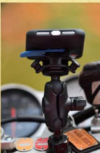
右側の縦ラインがハンドルロック式振動吸収ダンパー。底面に取り付けられるハンドルマウントとアームを使用効果が發揮されているのがわかる。
