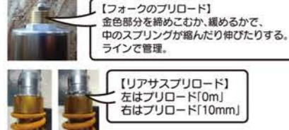
◆イメージとしては締めこめばサスペンションは高い位置で動き、緩めれば低い位置まで使って動く感じ。足付きをよくしたい時にプリロードを緩めるのはこのため。◆手ごたえとしては締めれば固く感じ、緩めれば柔らかく感じる。★フロントフォークはストローク(動き)が大きく変化が分かりやすいので積極的に変えてみよう!
