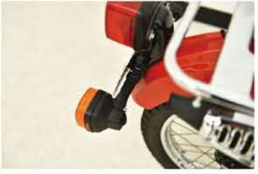
大変地味な部分であるが、リアウインカーステーは輸出仕様がゴム、国内仕様はフロント同様にスチール製。振動対策での変更だろうが、ゴム製は経年劣化で折れることがある。
