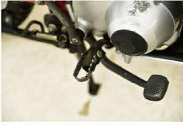
ステップは輸出仕様が鉄製のオフロードタイプで国内仕様はゴム製。海外ではハードな使用が想定されていたのだろう。
