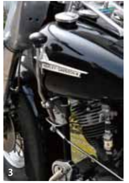
1:FLHらしく迫るフォークとブレーキ。2:フラットなフロントタイヤを穿き込むフューンダーアクセサリが美しい。3:タンク左サイドにあるハンドシフトはフルに固定されている。
