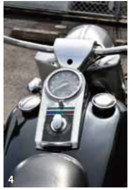
4:ガソリンタンクは左右に分かれており、真ん中にはLEDメーターとメカニカルスイッチなどのスイッチ。そして黒白などカラーリングが美しい。5:タンクにステンレス製のホルダーが何となく馴染みやすい。
